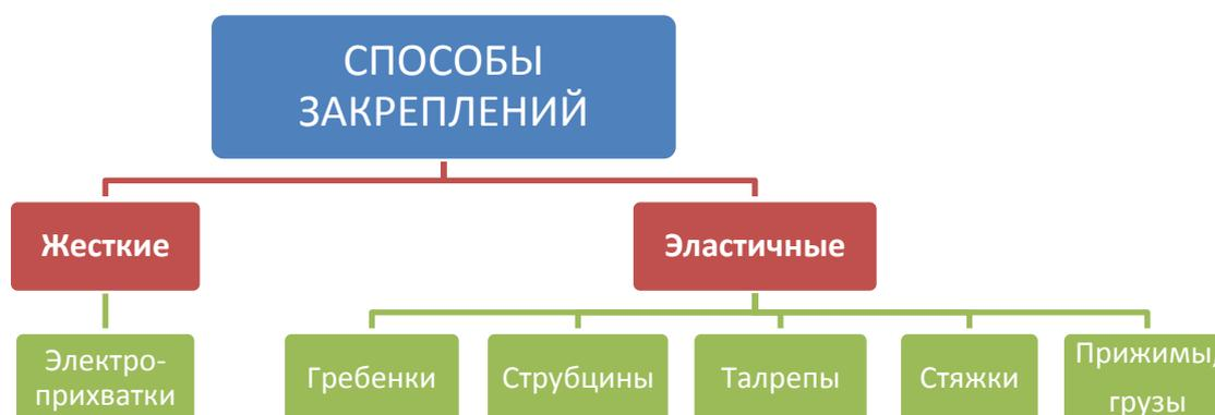
Рис.12.3 Способы закрепления сопряжений деталей.
