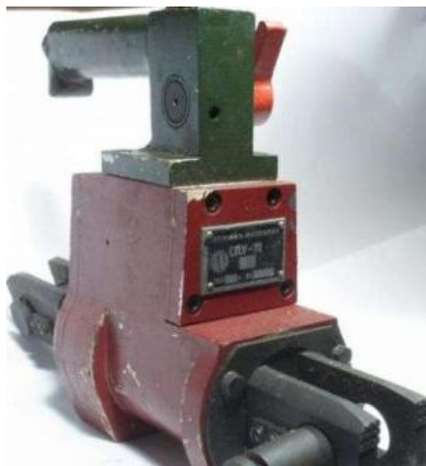
Рис. 12.9. Стяжка –распорка пневматическая СПУ-10.
