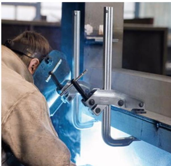
Рис. 12.16. Пример использования трубины при сварке в качестве эластичного прижима.
