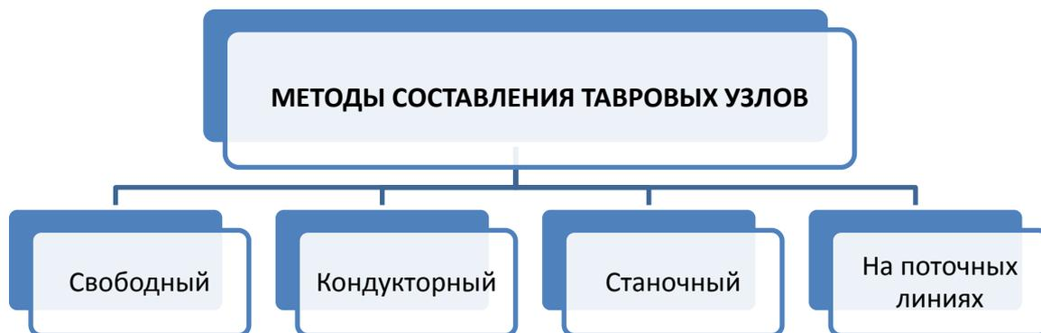
Рис. 12.24. Классификация методов изготовления тавровых узлов.
