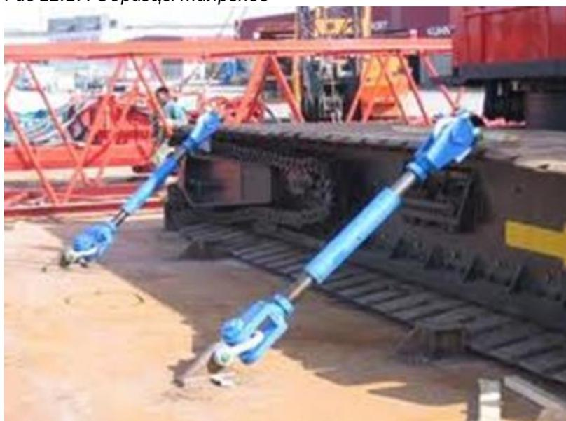
Рис 12.18. Пример использования талрепов
